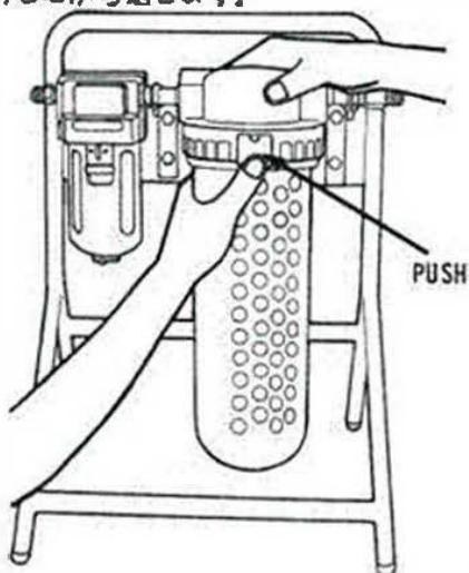
1. クランプリングを外し、内側の容器をカバーから取り外します。
