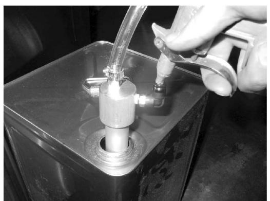
7. 洗浄キットのエア吸入口(部品番号④)にエアーガン等でエアを送り、溶剤をコンデンサーに流し込みます。
