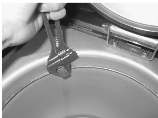
1. タンクから蒸気吸入口を外します。
