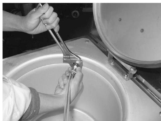
3. 洗浄キットのジョイント(部品番号⑦)のみをタンクの吸入口部分の先に締め付けた後、竹の子ユニオンジョイント(部品番号⑥)を接続します。
