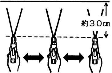
ガンは塗装面に向けて、約30cmの間隔を保ち、一定の速さで平行に移動します。
