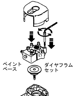
ダイヤフラムをセットごと交換し、組立てます。6本の六角穴付ボルトの締付けは対角線の順に均一に強く締付けてください。(締付トルク 90N·m)
