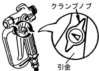
引金を引いた状態でノブの矢印がガンの先先を向くように回しながら引金を離します。再度引き直せば自動的に解除されます。
