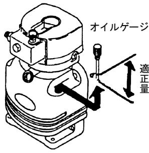
ドレンプラグが締まっていることを確認した後、オイルを約900cc入れてオイルゲージで確認してください。入れすぎると運転中にリリーフ弁から漏れ出します。
