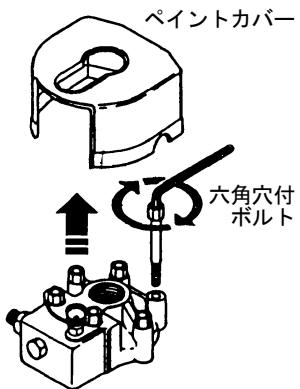
ペイントカバーを外します。6本の六角穴付ボルトを対辺8の六角レンチではずします。
