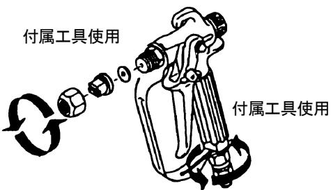
ノズルチップとガンフィルターの取外しは図の様にしてください。ノズルチップが詰まった場合は、ノズルチップを外してエアー等逆方向から吹付けて除去してください。取付の際には、パッキンが入っているか確認してしっかり締付けてください。
