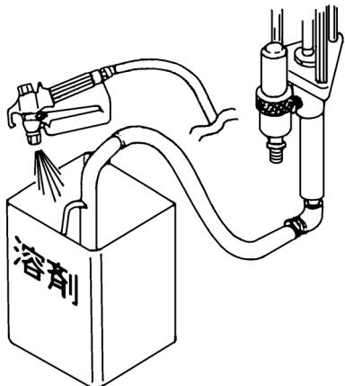
②エアレギュレーターのノブが低圧側いっぱいになっていることを確かめ、エアレスガンからチップを外し、塗料容器の内側に向け引金を引きます。
