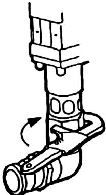
付属工具で吸入弁ナットを外す
